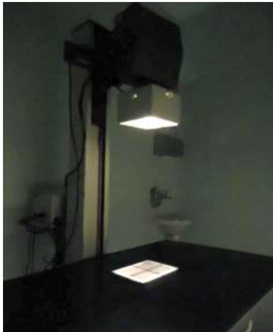
Figura 1 —Aparelho de raios X transportável usado na radiologia veterinária.
