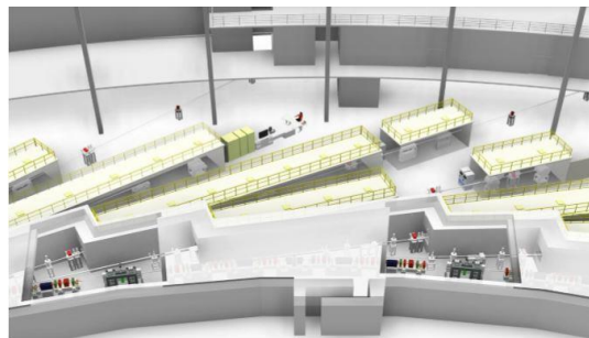
Figura 1: Representação da blindagem de concreto ao redor do acelerador e das linhas de luz. [7]
