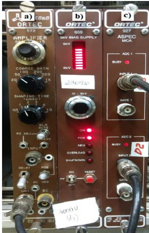
Fonte de alta tensão fabricada pela empresa ORTEC modelo 659, representada na
