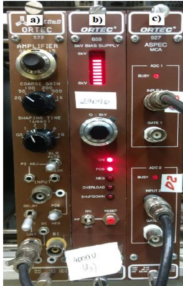
Figura 3: Sistema de espectrometria: a) amplificador; b) fonte de alta tensão; c) analisador multi canal.
