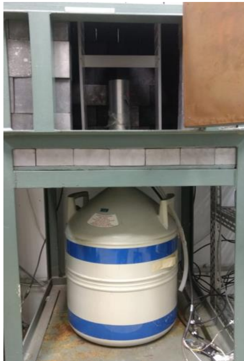
Figura 2: Detector de HPGe montado
