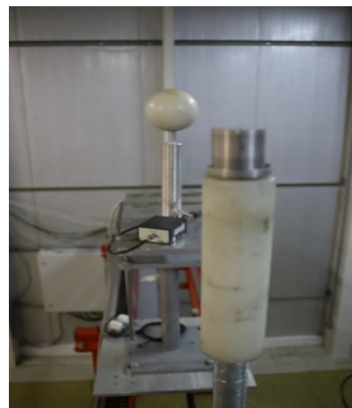
Figura 2: Configuração entre a fonte de nêutrons e o detector.
