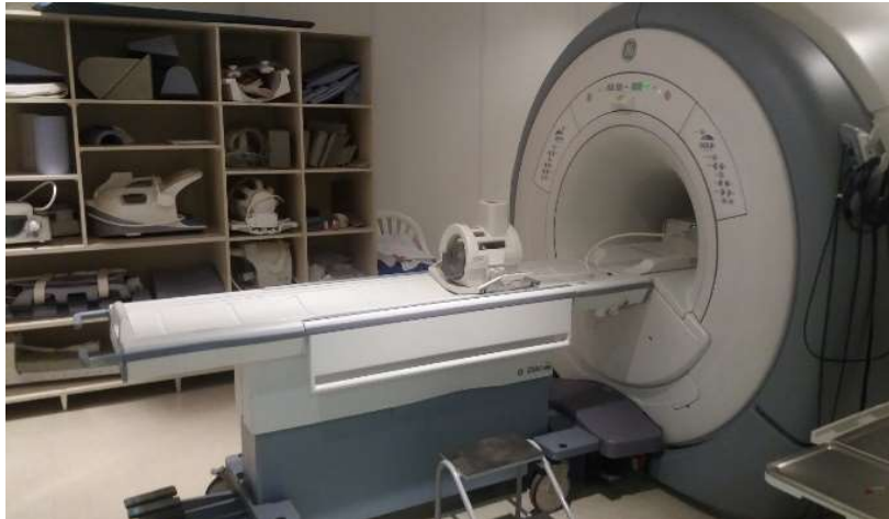
Figura 3: equipamento de RM. Amostras irradiadas do gel dosímetro foram inseridas em uma bobina de crânio para a geração das imagens.
