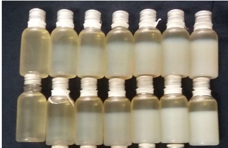
Figura 4: amostras de 30 ml de gel dosímetro irradiadas com diferentes valores de dose. Da esquerda para a direita na imagem: 0, 5, 10, 15, 20, 25 e 30 Gy.
