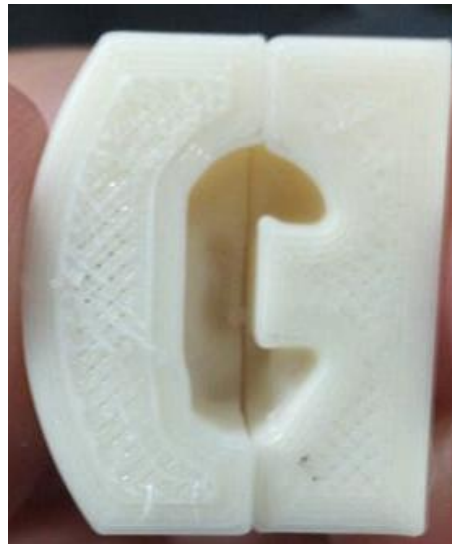
Figura 8. Modelo do Simulador de Tireoide impresso com tecnologia 3D com dimensões reduzidas.
