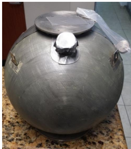
Figura 1 – Esfera de aço com diâmetro de 30 cm antes de ser preenchida com água leve [arquivo pessoal].
