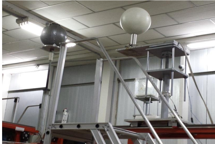
Figura 5 – Primeira medição realizada no LBM com a esfera de 12" a 100 cm de da fonte [arquivo pessoal].
