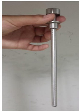
Figura 3 – Suporte da fonte a de ^{252}\text{Cf} [arquivo pessoal].
